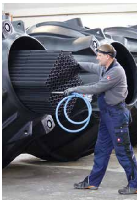
Production en série de lits fixes insérés plus tard dans DELPHIN® compact . Un contrôle de qualité durant la production assure une performance à long terme.
