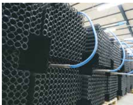
Production en série de lits fixes insérés plus tard dans DELPHIN® compact . Un contrôle de qualité durant la production assure une performance à long terme.
